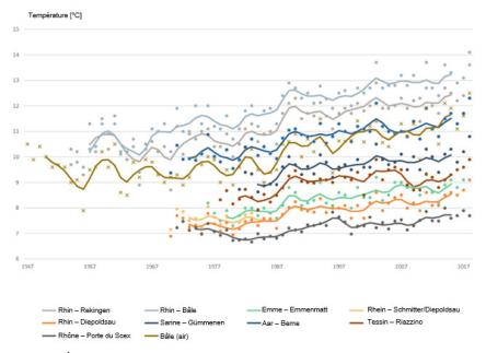
Fig. 3.2 : Évolution des températures dans les cours d'eau. Moyennes annuelles des températures de l'eau pour neuf stations de mesure de l'OFEV entre 1954 et 2018. Les moyennes annuelles glissantes sont calculées sur sept ans. La température de l'air à Bâle est indiquée à des fins comparatives (données de l'OFEV et de MétéoSuisse).
