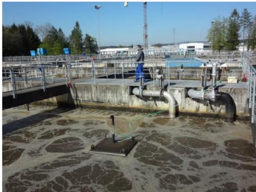
Die Messmethodik wurde im Rahmen der N2OKlimARA Kampagne bei 13 Schweizer Kläranlagen in Langzeitmessungen eingesetzt [33]. Für das Monitoring wird in Kap. 5.1. eine vergleichbare Messmethodik verlangt. Die Methodik entspricht damit derjenigen, die zur Ermittlung der Standard-Emissionsfaktoren im Rahmen des NIR eingesetzt wurde.
