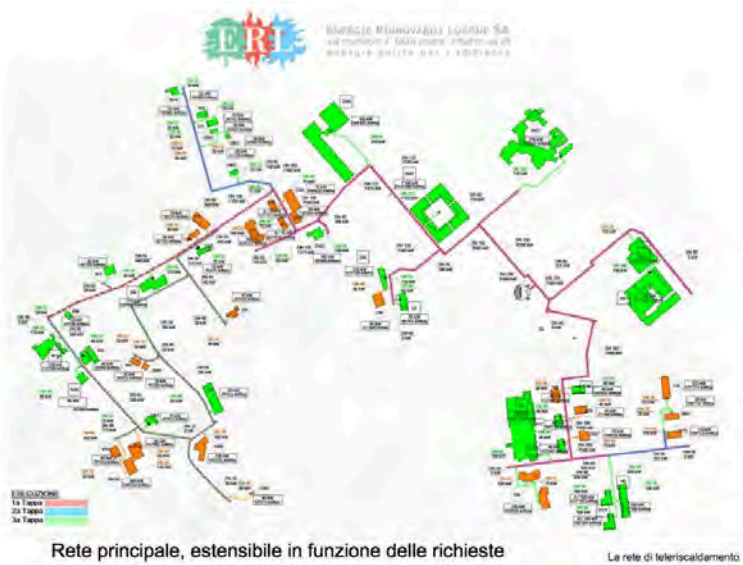
Abbildung 7: Geplantes Wärmeverteilnetz in Losone
