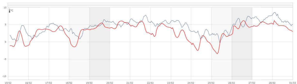
Anders als im Referenzszenario wird nicht  $T_a$ , sondern  $T_{\text{egain}}$  als Inputwert zur Bestimmung der Vorlauftemperatur ( $T_{\text{vorlau}}$ ) verwendet. Wenn  $T_{\text{egain}} > T_a$ , dann nimmt  $T_{\text{vorlau}}$  und damit der Brennstoffverbrauch gegenüber dem Referenzszenario ab. Abbildung 4.4.2 zeigt den Zusammenhang grafisch.
