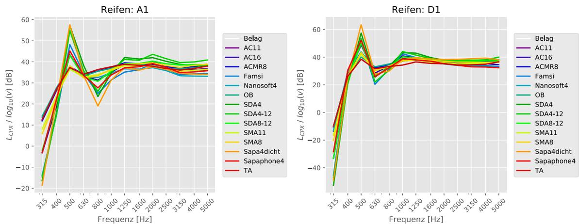
Abbildung 9: Spektrale, Belagsspezifische Geschwindigkeitskorrekturen für die Reifensets PKW (A1) und LKW (D1).
