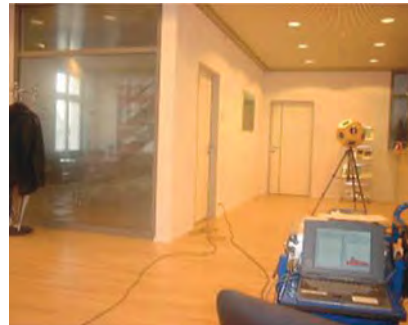
Messung zur Kontrolle des Schallschutzes nach SIA-Norm 181.
