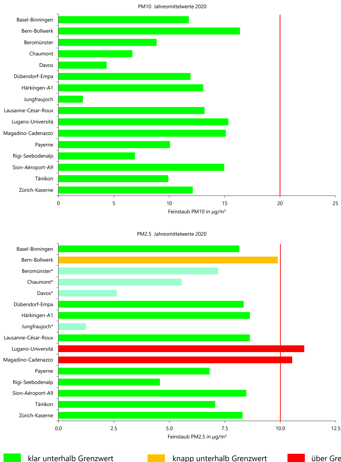
Abb. 2: Vergleich der Jahresmittelwerte 2020 von PM10 (oben) und PM2.5 (unten) mit den Immissionsgrenzwerten (PM10 Grenzwert: 20 µg/m³; PM2.5 Grenzwert: 10 µg/m³). *Bei den PM2.5 Jahresmittelwerten der Stationen Beromünster, Chaumont, Davos-Seehornwald und Jungfrauoch handelt es sich um orientierende Werte, welche mittels optischer Feinstaubmessung bestimmt wurden.
