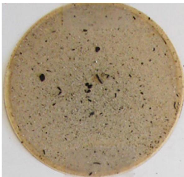
**Abbildung 29: Planfilter nach der Probenahme an einer automatischen Holzfeuerung beim Betrieb mit Waldhackschnitzeln und vor dem Multizyklon (Rostfeuerung 300 kW, Stand der Technik vor 2000) mit Staubemissionen zwischen 300 – 500 mg/m<sup>3</sup> (bei 13 Vol.-% O<sub>2</sub>) (Foto HSLU).**
