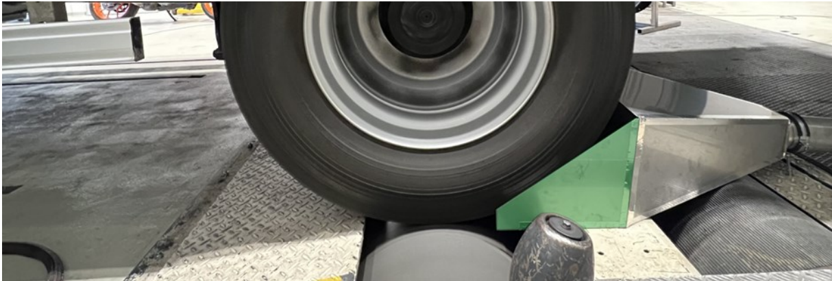
Abbildung 4-3: Absaugtrichter mit Leitblech (grün hervorgehoben) für Reifenabriebemissionen am LKW-Rollenprüfstand. Der LKW ist auf der angetriebenen Hinterachse auf den Scheitel eines Zwillingssrollenkörpers aufgespannt
