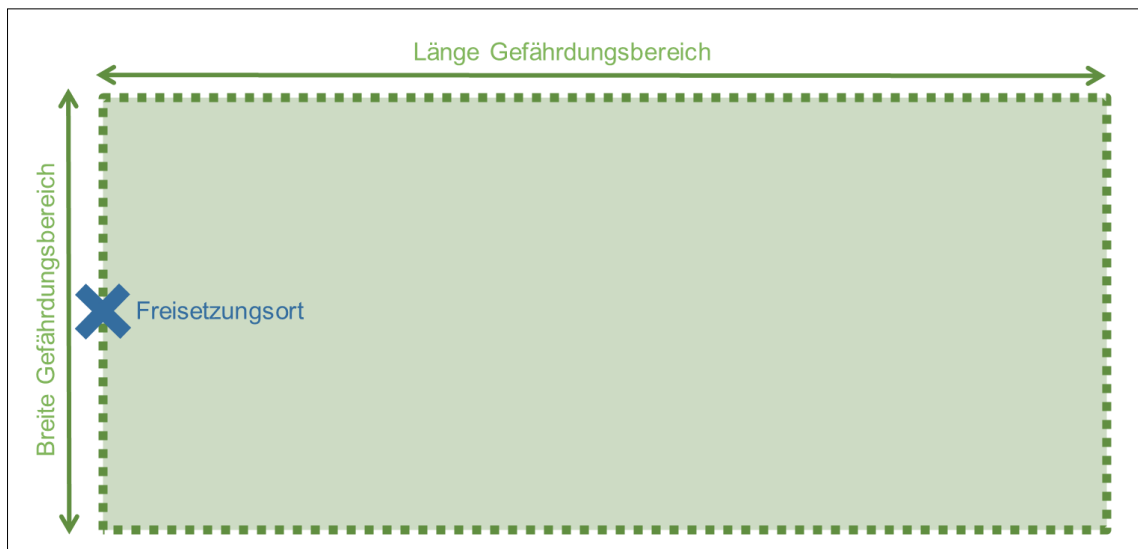
Abbildung 11: Schematischer Gefährdungsbereich einer Ammoniakwolke mit einer mittleren Letalität von 28 % (gültig für Freisetzungsraten von 1 bis 6 kg/s).
