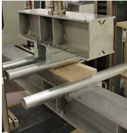
Abbildung 2: Prüfaufbau zur Ermittlung der Biegefestigkeit von keilgezinkten Brettern
