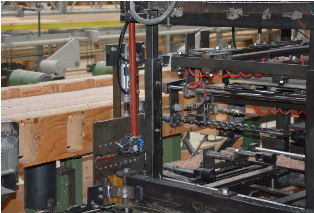
Abb. 5: Bohreinheit der Brettstapelmaschine
