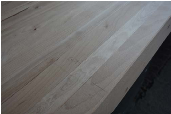
Abb. 10: Brettstapelement aus Buche nach dem Hobeln
