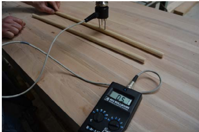
Abb. 6: Feuchtigkeitsmessung der Fichten- und Buchendübel
