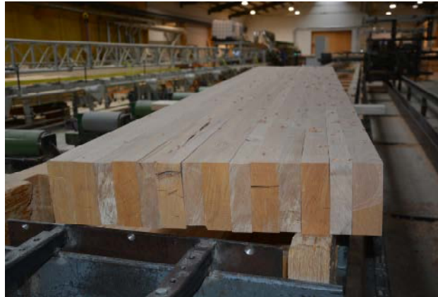
Abb. 3: Buchenbrettstapelelement und Brettstapelmaschine
