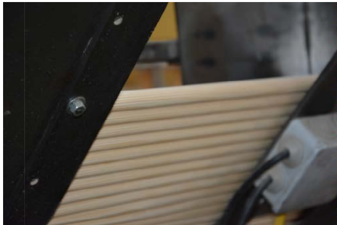
Abb. 7: Dübelaggregat der Brettstapelmaschine
