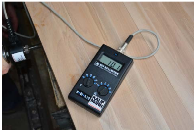
Abb. 4: Feuchtigkeitsmessung der Buchenlamellen
