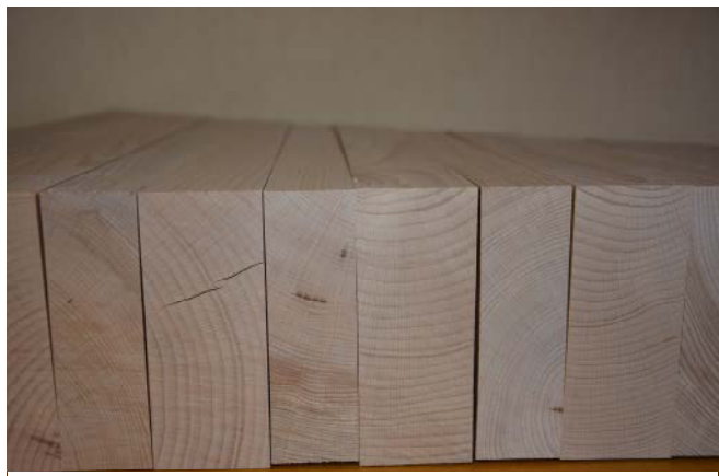
Abb. 16: Buchenbrettstapel nach sechs Monaten Lagerung im Innenbereich (Feuchtklasse 1)
