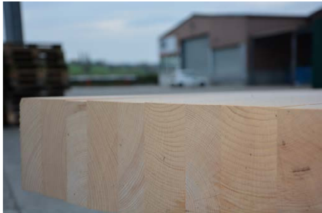
Abb. 15: Buchenbrettstapel nach sechs Monaten Lagerung im, vor direkter Bewitterung geschützten Aussenbereich (Feuchtklasse 2)
