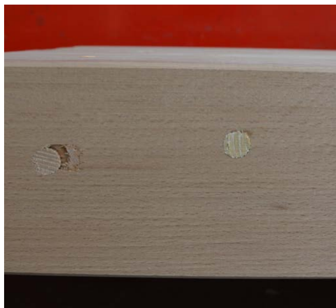
Abb. 8: Links: Buchendübel gebrochen, rechts Fichtendübel
