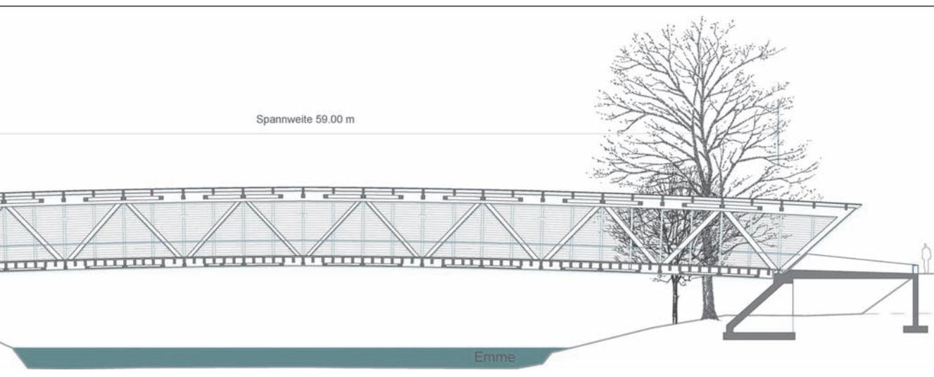
Das zur Ausführung bestimmte Projekt «Neumattbrücke»: Der Längsschnitt zeigt die wichtigsten Strukturelemente des transparent wirkenden Tragwerkes in BSH-Fachwerkausführung.
