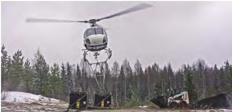
Abb. 11: Helikopter beim Wechseln des Streucontainers und Bobcat-Lader für die Beladung der Container (Emilsson 2006).
