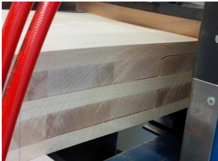
Abbildung 16: Typisches Bruchbild Rollschubprüfung Prüfkörper 1
