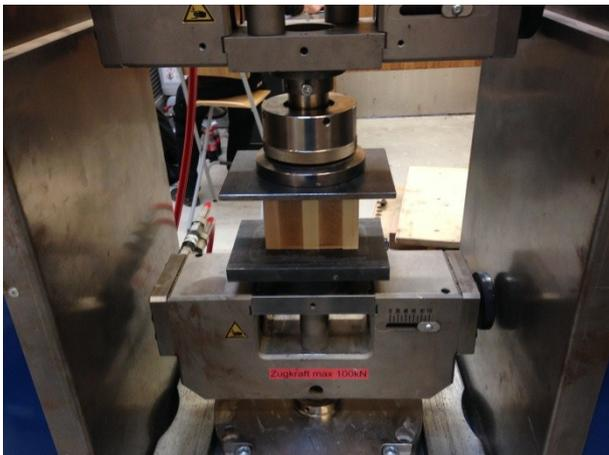
Abbildung 42: Prüfungsaufbau Druck in Plattenebene parallel zur Decklage
