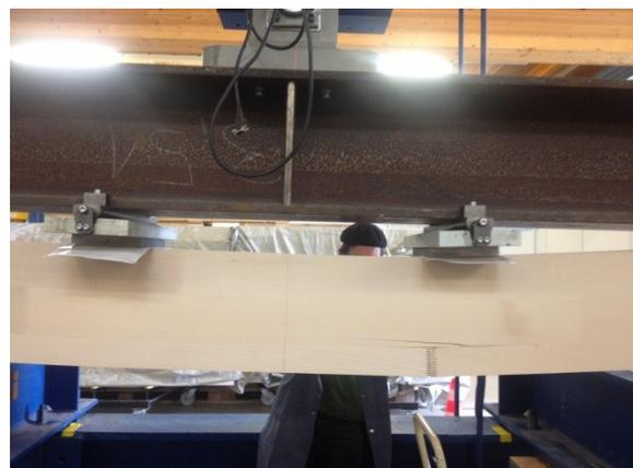
Abbildung 39: Bruchbild Biegefestigkeitsprüfung Prüfkörper 10b
