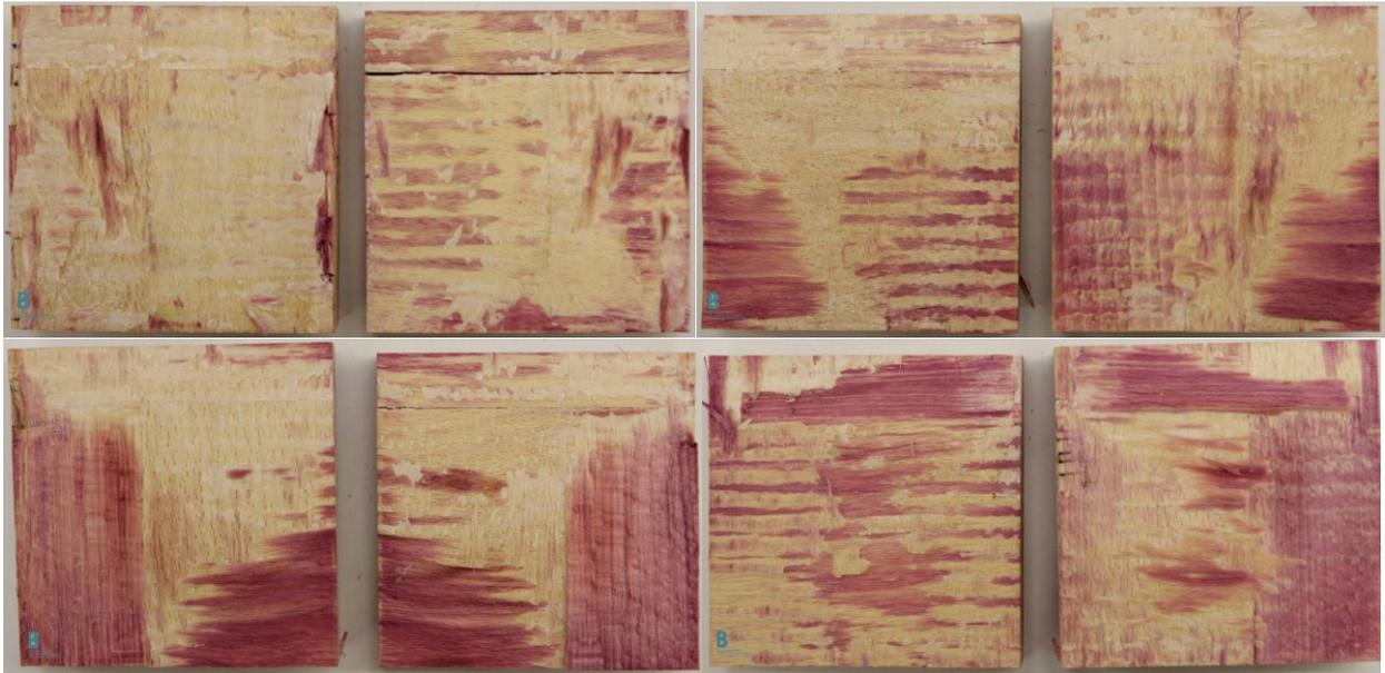
Abbildung 26: Faserbruchanteil Prüfkörper 10
