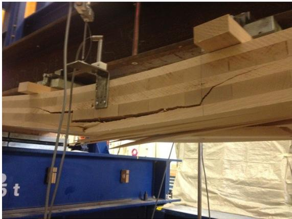
Abbildung 8: Typisches Bruchbild Biegeprüfung liegend Prüfkörper 2
