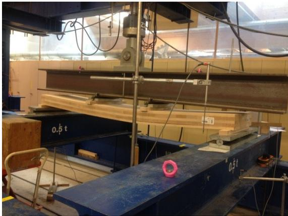
Abbildung 30: Bruchbild Steifigkeitsprüfung Prüfkörper 4
