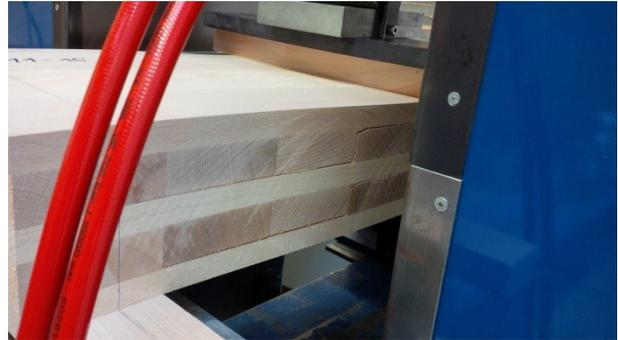
Abbildung 41: Bruchbild Rollschub
