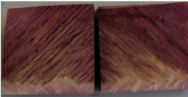
Abbildung 12: Faserbruchanteil Prüfkörper 5, Fuge 1
