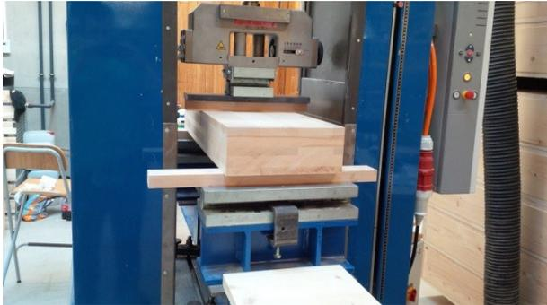
Abbildung 40: Prüfungsaufbau Rollschub
