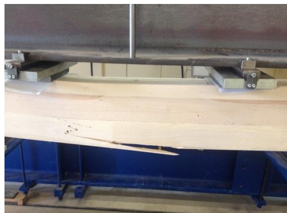
Abbildung 38: Bruchbild Biegefestigkeitsprüfung Prüfkörper 10a
