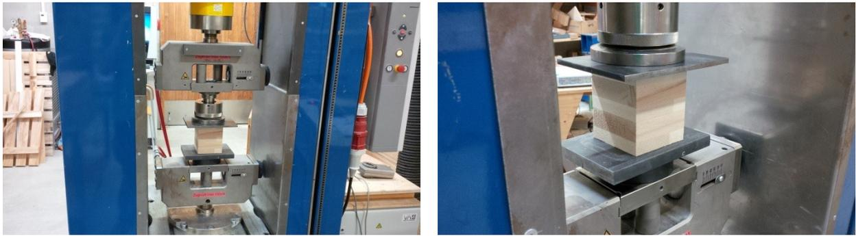
Abbildung 44: Prüfungsaufbau Druck senkrecht zur Plattenebene
