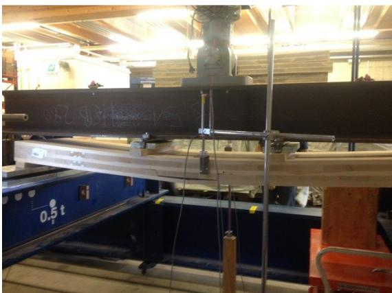
Abbildung 29: Bruchbild Steifigkeitsprüfung Prüfkörper 3
