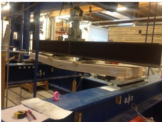
Abbildung 32: Bruchbild Steifigkeitsprüfung Prüfkörper 6
