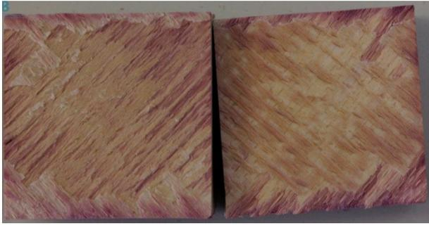
Abbildung 11: Faserbruchanteil Prüfkörper 4, Fuge 3
