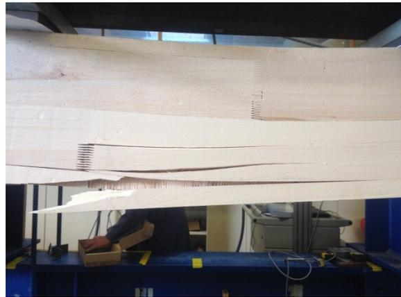
Abbildung 34: Bruchbild Biegefestigkeitsprüfung Prüfkörper 8a
