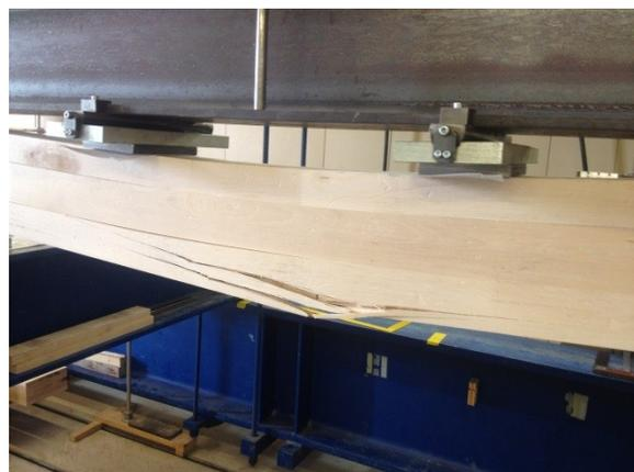
Abbildung 36: Bruchbild Biegefestigkeitsprüfung Prüfkörper 9a
