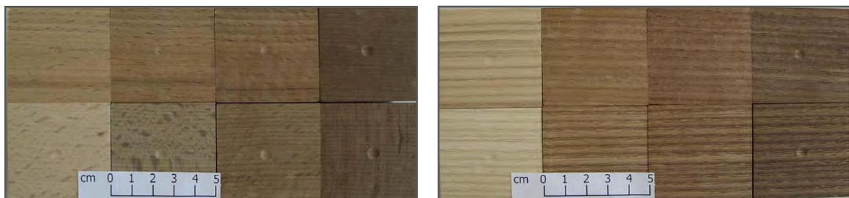
Abb. 3-34: Behandlung von Buche (links) und Esche (rechts) bei 180 °C und unterschiedlicher Dauer. Von links nach rechts: unbehandelt, 6h, 12h, 24h (Oelhafen 2005)
