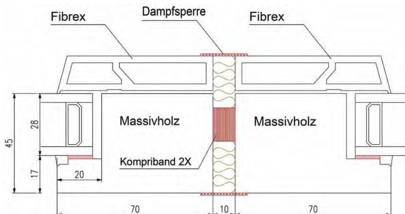
Abb. 3-13: Querschnitt eines geprüften Fensters mit Fibrex-Vorsatzschale (Berner Fachhochschule 2007)
