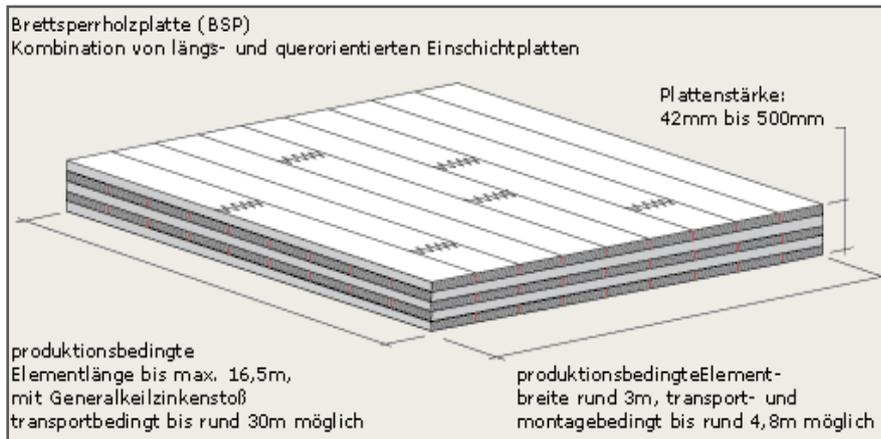
Abb. 3-26: Aufbau und Kennwerte von Brettsperrholz (pro:Holz)
