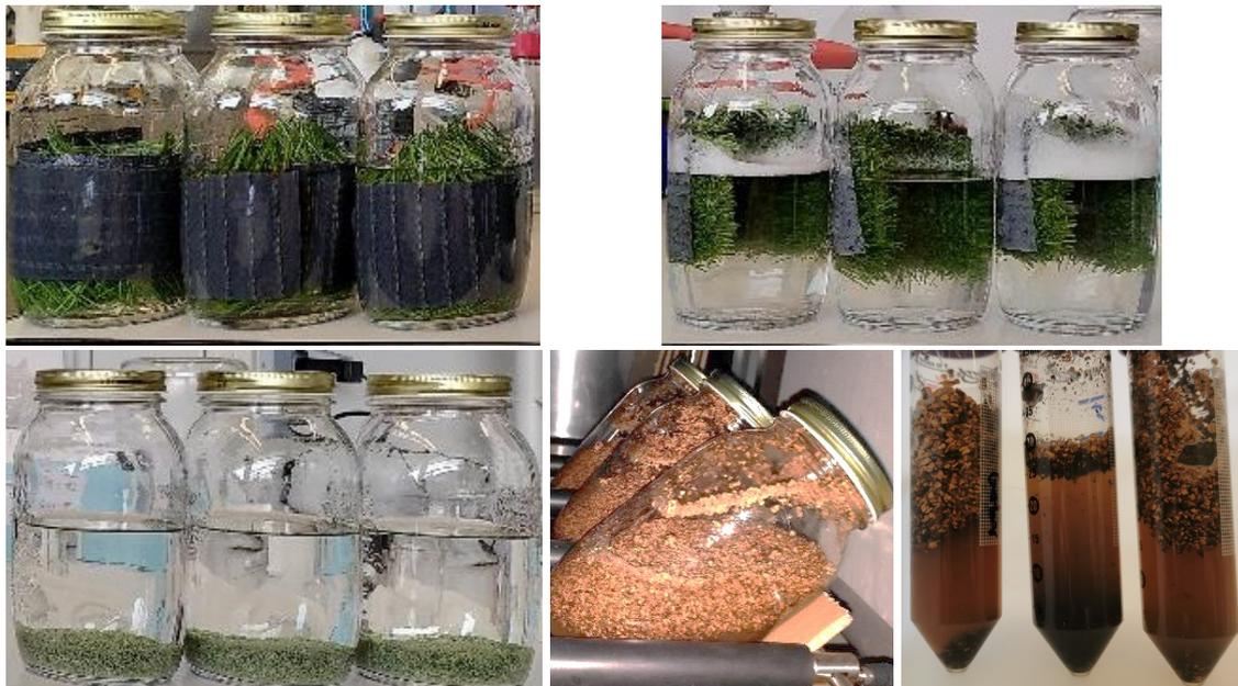
Abbildung 22: Rasenstücke (oben), EPDM-Granulate (unten links) und Korkgranulat (unten Mitte und rechts) auf dem Horizontalschüttler nach 24 h Elution.
