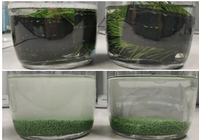
**Abbildung 15:** Kunststoffrasen (oben) und synthetisches Füllgranulat (unten) nach 24 h Elution bei +20 °C (links) und +60 °C (rechts).
