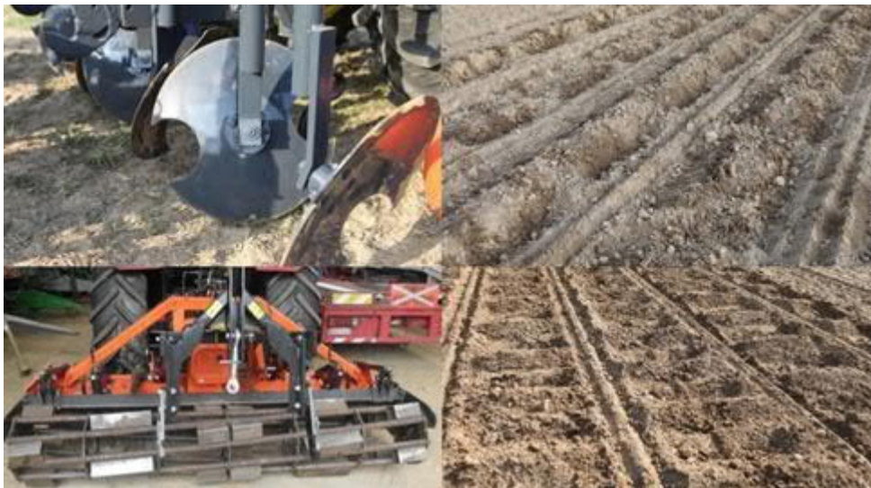
Abbildung 3 Modifizierter Scheibenpflug (oben) und umgebaute Rohrstabwalze (unten) und die dazugehörigen bearbeiteten Bodenoberflächen (rechts). Quelle: Sittig et al. 2020.
