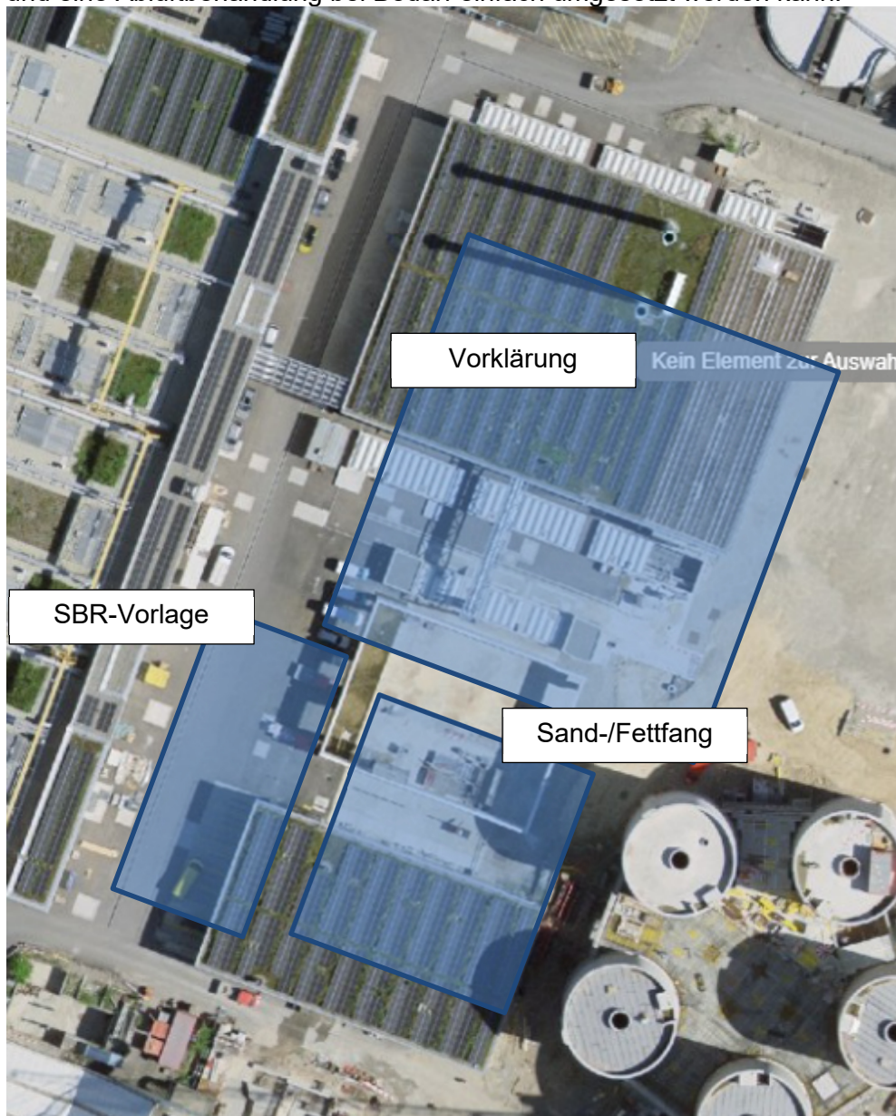
Abbildung 21: Beispiel für unterirdische Becken der ProReno Basel. Gut sichtbar sind die Revisionsklappen beim Sand-/Fettfang und Vorklärbecken. Der Platz über dem Vorklärbecken wird für die Werkstatt genutzt. © Data: swisstopo
