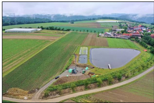
Abbildung 6: links: Stahlsilo bei einem Beerenproduzenten in Aesch LU mit 805 m 3 Speicherkapazität (Eppenberger 2020); rechts: zwei kleinere Teiche klären das Wasser, bevor es in den grossen Bewässerungsspeicher (20.000 m 3 ) fliesst, Gemüseproduzent in Deutschland (Foto: (Deter and Eghbal 2020) bioland-Fachmagazin).
