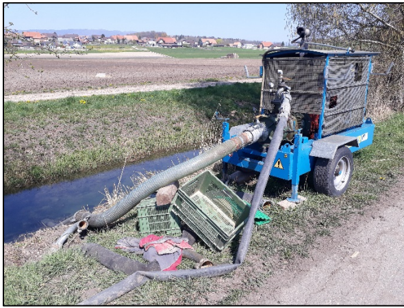
Abbildung 16: Mit Dieselmotoren betriebene Pumpen fördern Bewässerungswasser auf die Felder im Seeland (Fotos: Elke Kellner).
