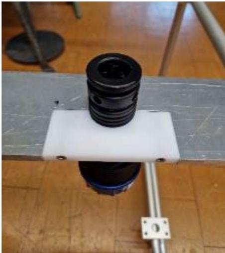
5. **Lampen montieren:** Den Lampenkopf am Ende der Lampe anschrauben. Die Lampe durch das Loch schieben, bis sie die Halterung berührt, und dann etwa 2mm nach unten bewegen. Die beiden Schrauben anziehen, um die Lampe festzuklemmen. Der Lampenkopf muss sich lösen lassen, ohne dass sich der Rest der Lampe dreht.
