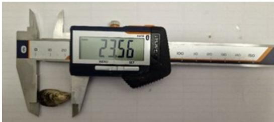
Digitaler Messschieber HCT IP67 mit Bluetooth. Falls die Werte nicht direkt in die Shell\_length-Datei eingetragen werden, siehe Kapitel Anweisungsdatenblätter Quaggamonitoring, um sicherzustellen, dass die Werte korrekt eingetragen werden.
