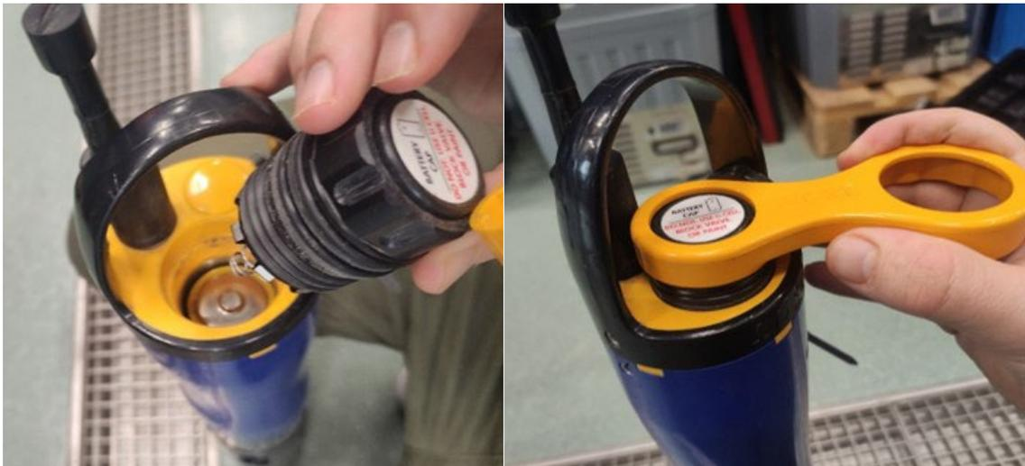
2. Der DO-Sensor (Sauerstoffsensor) muss stets feucht bleiben. Ein Deckel kann aufgebracht werden, um dies sicherzustellen. *Vor der Probenahme muss der Gummideckel entfernt werden.* Falls kein Deckel verwendet wird, sollte der DO-Sensor, wenn er sich nicht im Wasser befindet, regelmässig mit Wasser besprüht werden.
