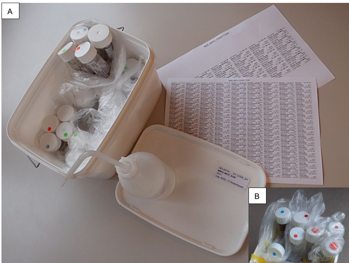
Abbildung 9: A: Empfohlenes Verpackungssystem für den Versand der EPT-Arten für die Qualitätskontrolle. Für einen Standort werden alle mit einem Farbpunkt markierten PP EPT-Röhrchen in einem Beutel gesammelt und in einen Eimer für den Versand gegeben. Auf den Deckel des Eimers werden ein oder mehrere «Wiko-Etikette 1x» mit dem Namen des Mitarbeiters geklebt. B : Falls das Material an getrennte EPT-Experte geschickt wird, können die PP EPT-Röhrchen pro Farbe in einen Beutel gegeben werden.
