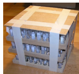
Abbildung 10: Alternatives Verpackungssystem für den Versand der EPT-Arten für die Qualitätskontrolle. Die Proben werden nach Standort und Ordnung getrennt auf Lochplatten geordnet. Die Platten können für den Versand jeweils zu dritt übereinander gestapelt werden.
