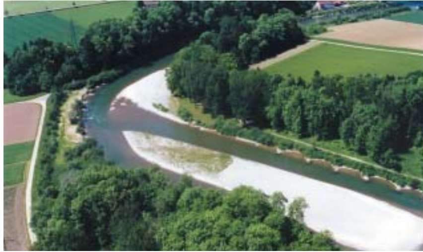
Aufgeweiteter Thurlauf bei Gütighausen ZH: Der moderne Hochwasserschutz schliesst auch die Schaffung von natürlichen Rückhalteräumen mit ein, wo ein Fluss bei Hochwasser ohne grössere Schadenfolgen über die Ufer treten darf.
