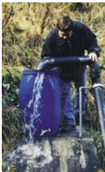
Minutiöse Überwachung der Talsperren: Kontrolle der Mauerbewegungen im Innern der Grande Dixence (links), Sickerwassermessung bei der Anlage Isel GR (Mitte) und Überwachung von Neigungsänderungen der Staumauer Molina GR (rechts).
