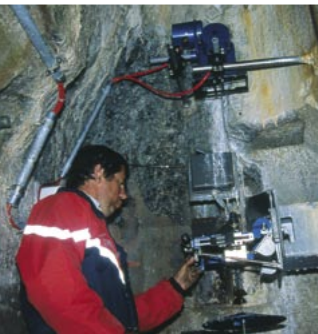
Minutiöse Überwachung der Talsperren: Kontrolle der Mauerbewegungen im Innern der Grande Dixence (links), Sickerwassermessung bei der Anlage Isel GR (Mitte) und Überwachung von Neigungsänderungen der Staumauer Molina GR (rechts).
