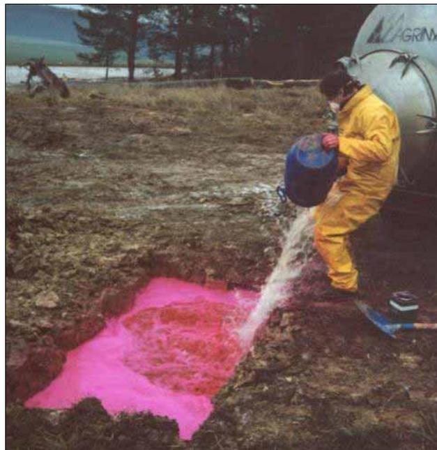
Abb. 9: Eingabe des Farbtracers Sulforhodamin B in ein ausgehobenes Erdloch (Foto I. Favre).
