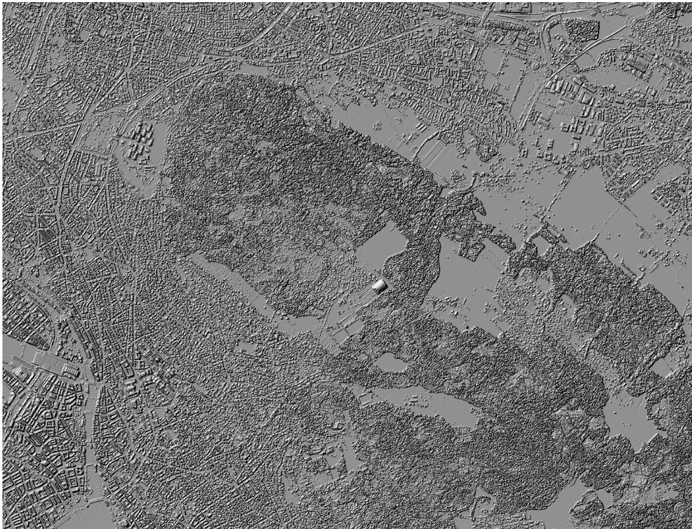
Abb. 15 Schattierter Ausschnitt Zürich Nord, wie Abb. 13 und Abb. 14, aus dem digitalen Höhenmodell als Differenz zwischen digitalen Oberflächen- und Terrainmodell (Massstab 1:50'000, reproduziert mit Bewilligung von swisstopo JA100001)
