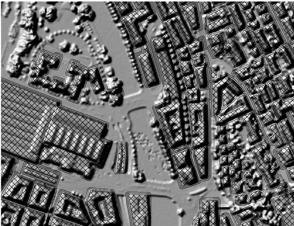
Abb. 18 Schattierter Ausschnitt Zürich Hauptbahnhof aus dem digitalen Oberflächenmodell überlagert mit Gebäuden (schraffiert) und den zusätzlichen 3 m und 6 m Puffern (Massstab 1:5'000, reproduziert mit Bewilligung von swisstopo JA100001)
