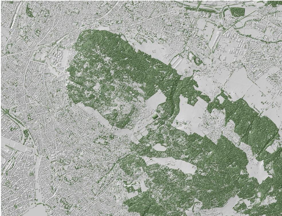
Abb. 19 Schattierter Ausschnitt Zürich Nord aus dem digitalen Oberflächenmodell mit überlagerter Baum-/Nichtbaummaske in 2 m Auflösung (Massstab 1:50'000, reproduziert mit Bewilligung von swisstopo JA100001)
