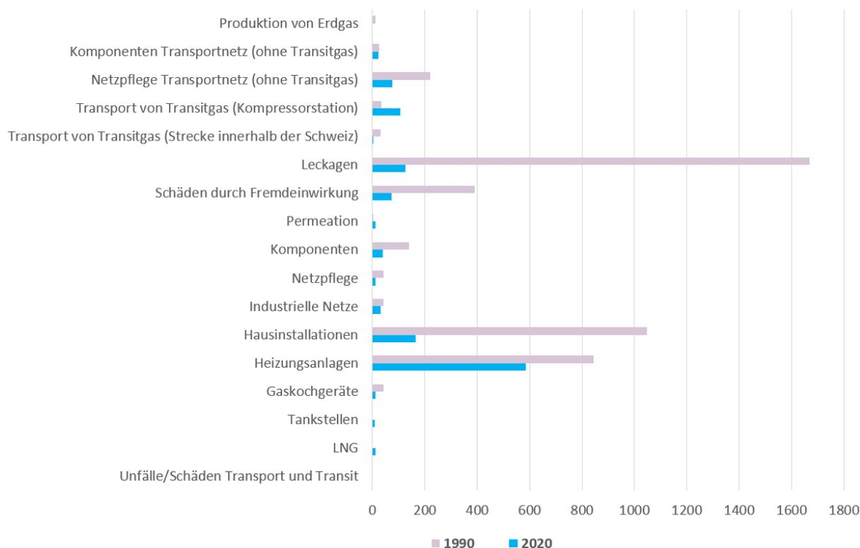
Abbildung 28: Spezifische Methanemissionen Schweiz, berechnet mit der neuen Methodik
