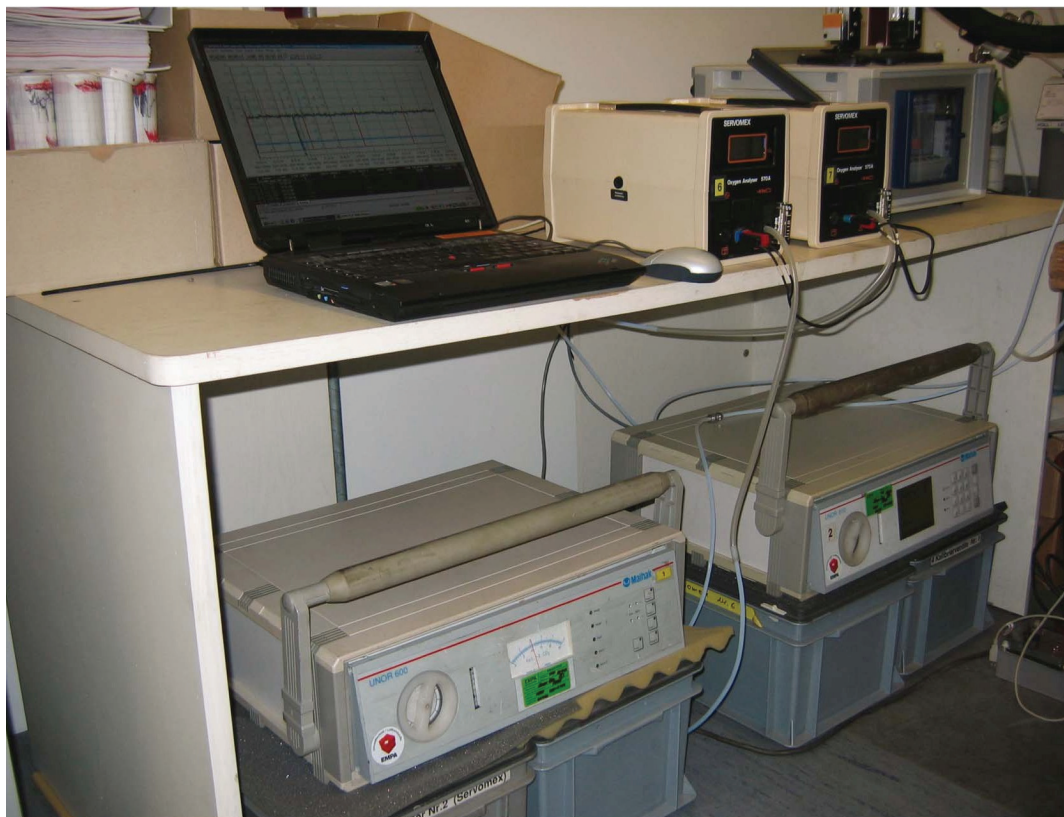
Abbildung 5 Verwendetes Setup zur Bestimmung der O 2 und der CO 2 Konzentration
