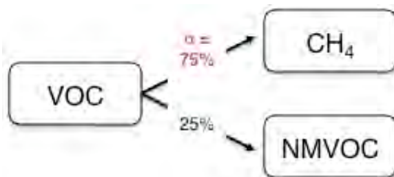
Bild 3.5 Fraktionierung der Kohlenwasserstoffe nach Arbeitsblatt BAFU 2005.
