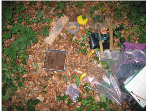
Abb. 2-2: Material zur Entnahme der volumen- proportionalen Bodenproben
