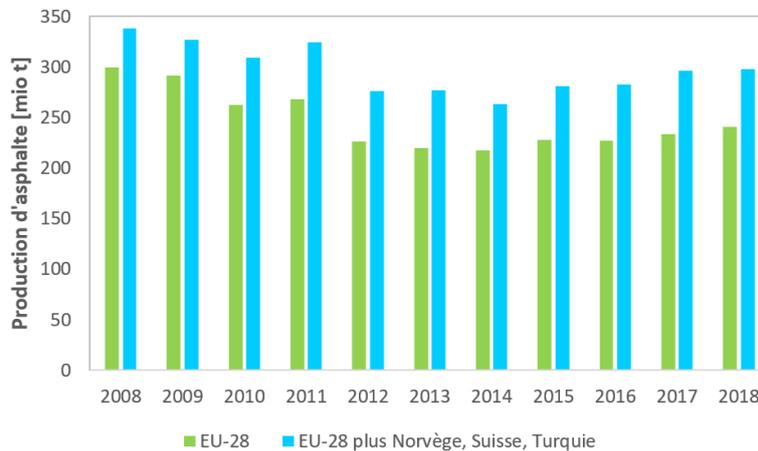
Figure 6 : Production totale d'enrobés à chaud et à tiède dans l'UE-28 (en vert) et l'UE-28 plus la Norvège, la Suisse et la Turquie (en bleu) au cours de la période 2008-2018 (données tirées de [8])
