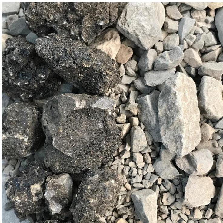
Figure 33 : Agrégats bitumineux 16/70 avant (à gauche) et après (à droite) le traitement chimique
