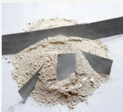
Récupération du zinc provenant des cendres des usines d'incinération
