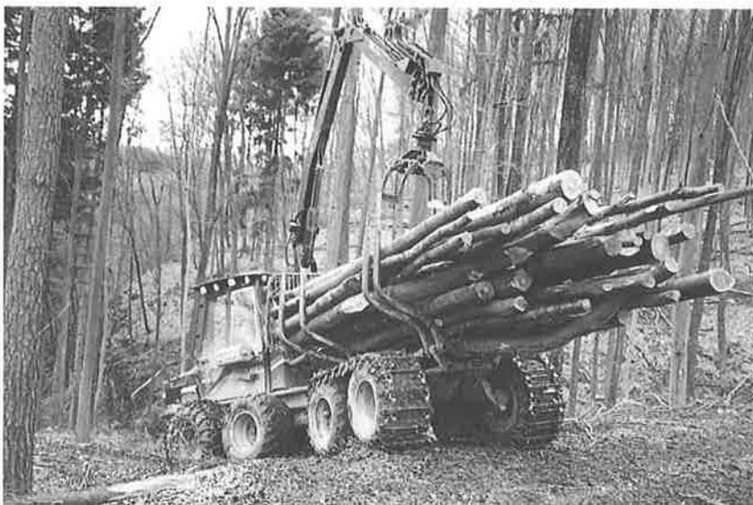
Fig. 3: Un porteur puissant équipé de chenilles aux essieux arrière Photo: R. Zimmermann
