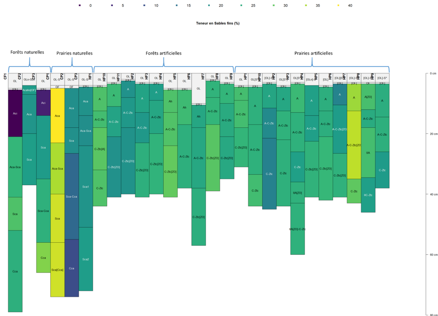
Figure F.4 : Teneur en sables fins (%), par horizon, en fonction de la profondeur du sol. Les sites de référence de Cornaux (à gauche ; CF et CP) et les sites artificiels d'Hauterive-St-Blaise (à droite ; HF et HP) sont représentés. Pour simplifier la lecture des noms d'horizons, le suffixe «ca» qui indique la présence des carbonates a été omis dans les sols artificiels, ainsi que la différence entre vieille litière (OLv) et litière nouvelle (OLn).
