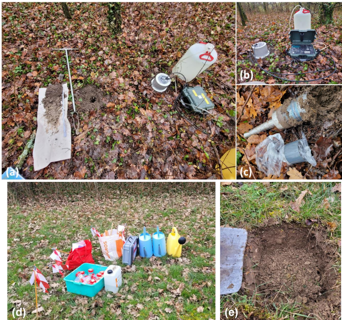
Figure 3. (a) Exemple de sondage à la tarière dans une des zones de bosquets à Hauterive–St-Blaise. (b) Infiltromètre SATURO (METER Group) utilisé pour la mesure de l'infiltration de l'eau à saturation. (c) Echantillonnage de cylindres de sols pour la mesure de la densité et la porosité des horizons de surface. (d) Matériel pour la collecte de vers de terre. (e) Première étape de creusage du profil de sol. ©Crédits photos : Teo Zanini (a, b, c), Claire Le Bayon (d, e).
