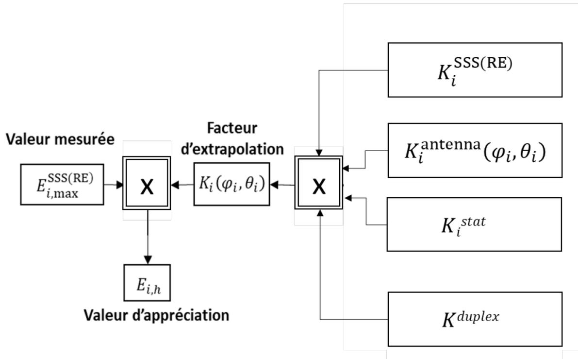
Figure 4: Ordinogramme de la méthode de mesure de réception pour une cellule  $i$ . La figure illustre schématiquement la procédure de détermination du facteur d'extrapolation et la multiplication de celui-ci avec la valeur mesurée pour obtenir la valeur d'appréciation.
