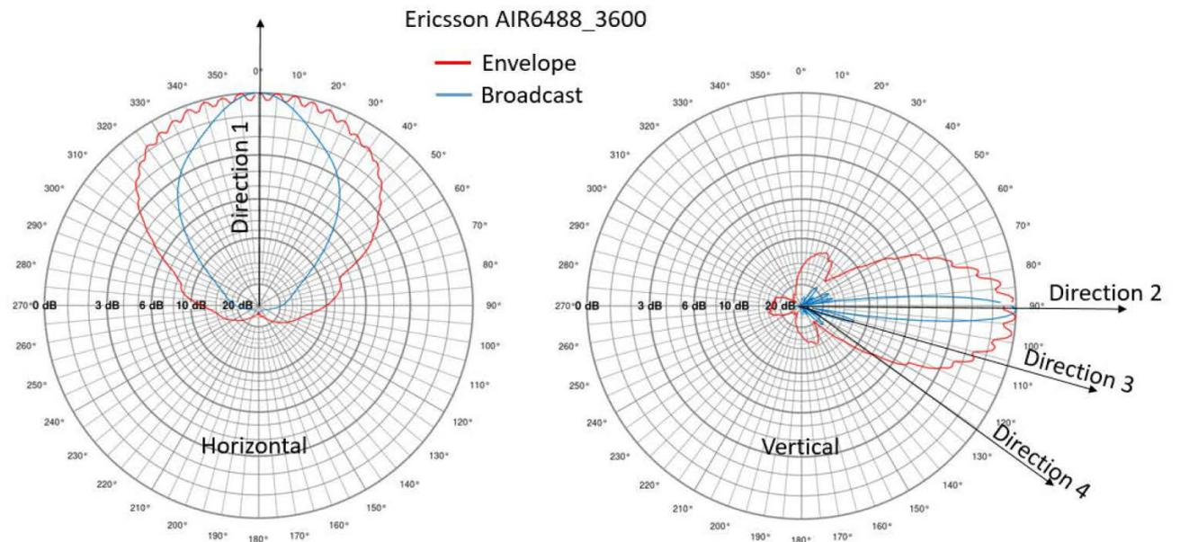
Figure 3: Diagrammes d'antenne Ericsson AIR6488\_3600 avec le diagramme de signalisation (en bleu, Broadcast) et le diagramme total (en rouge, Envelope) normalisés à 0 dB.
