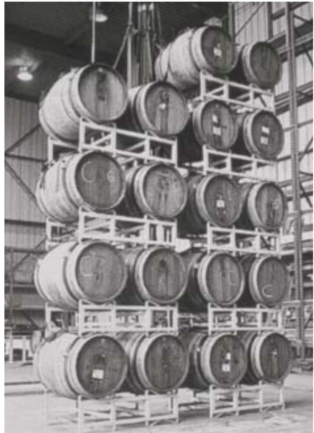
35/9 On peut même tester des châssis à tonneaux de vin sur une table vibrante servant à simuler des séismes... (Berkeley, 2000).
