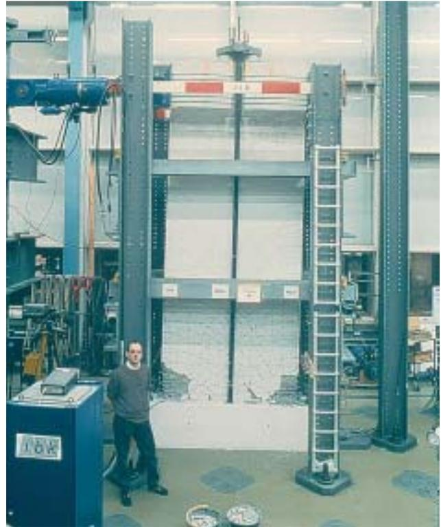
23/1 Des essais statiques cycliques opérés dans la partie inférieure d'une paroi porteuse en béton armé de six étages à l'échelle 1:2 ont démontré l'efficacité d'une structure ductile [Da 99]. Les parois dimensionnées en capacité ont permis d'obtenir sans surcoût notable une tenue au séisme trois à quatre fois supérieure à celle atteinte par les parois dimensionnées de manière traditionnelle, selon la norme SIA 162.
