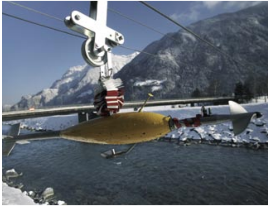
Les moulinets hydrométriques, comme d'autres appareils, sont calibrés dans le canal d'étalonnage de l'OFEG à Ittigen BE (voir cadre). Ces instruments sont utilisés pour mesurer la vitesse d'écoulement des cours d'eau.
