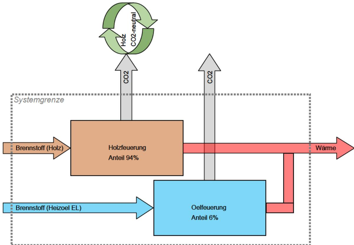
"Wärme" bezieht sich auf die Nutzenergie, die an den Wärmeverbund angeschlossene Liegenschaften unter Berücksichtigung der Nutzungsgrade, ohne Wärmeverluste des Fernwärmenetzes, erhält.
