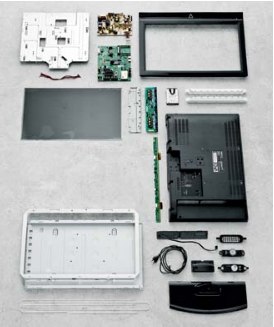
Un écran LCD pèse en moyenne 6,2 kilos. Le boîtier noir permet de récupérer 1,5 kilo de plastique. De même, le métal, les modules de verre et les modules LCD ainsi que les câbles de cuivre peuvent être valorisés.
