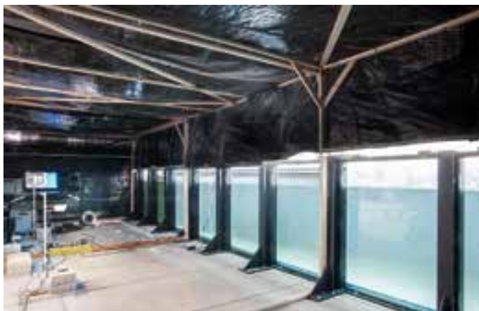
En collaboration avec l'association Aare-Rheinwerke, le laboratoire d'hydraulique VAW et l'institut de recherche sur l'eau Eawag étudient à l'EPFZ le comportement des poissons migrateurs dans un canal de simulation.
