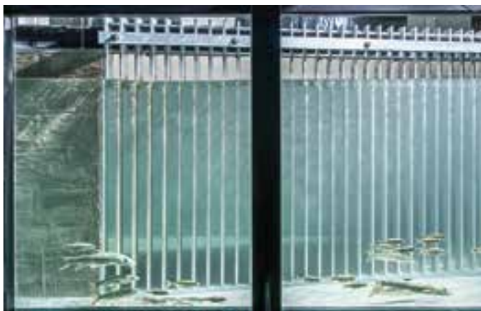
En collaboration avec l'association Aare-Rheinwerke, le laboratoire d'hydraulique VAW et l'institut de recherche sur l'eau Eawag étudient à l'EPFZ le comportement des poissons migrateurs dans un canal de simulation.
