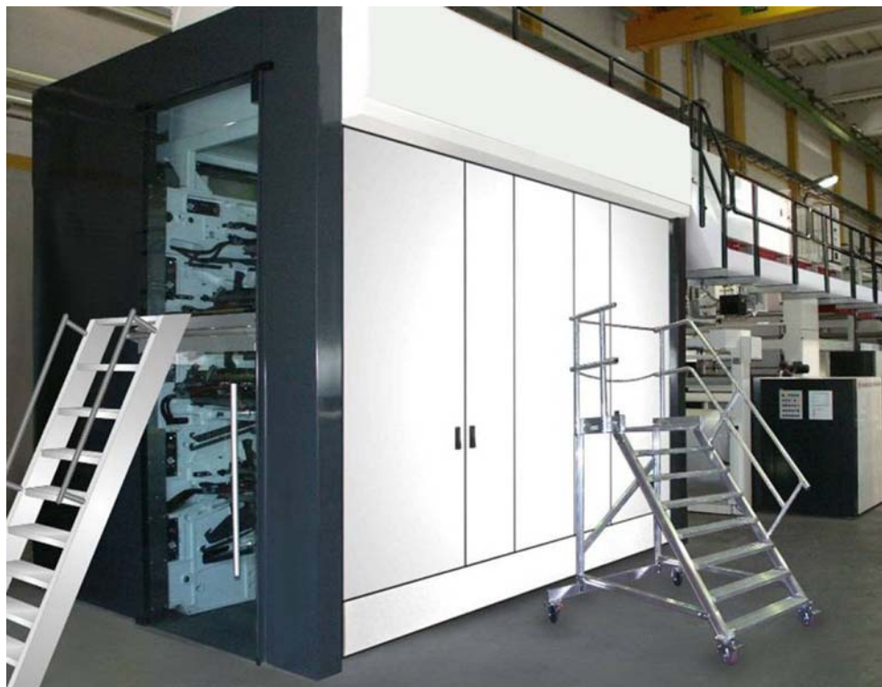
Fig. 3 > Unité d'impression flexo entièrement encoffrée (verre de sécurité pour le contrôle visuel)
