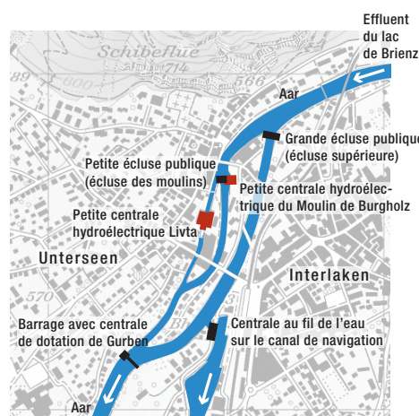
En période normale, l'eau s'écoule par les deux petites centrales hydroélectriques de Livta et du Moulin de Burgholz et, lorsque le débit atteint 26 m 3 /s, également par la grande écluse publique. La petite écluse publique n'est utilisée qu'en cas de débits particulièrement élevés (ou lors de travaux de révision sur la grande écluse).
