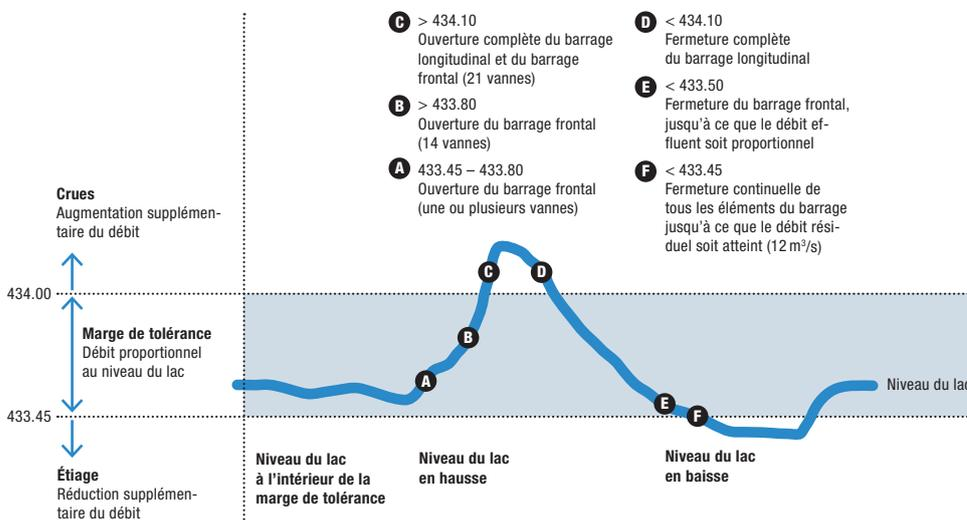
Cette régulation permet au lac des Quatre-Cantons de conserver un régime naturel à l'intérieur d'une marge de tolérance et l'empêche, en situation normale, de descendre sous la cote de 433,25 m.s.m. L'ouverture ou la fermeture des barrages frontal et longitudinal nécessitent pour chacune l'intervention de quatre à six personnes pendant une journée de travail.
