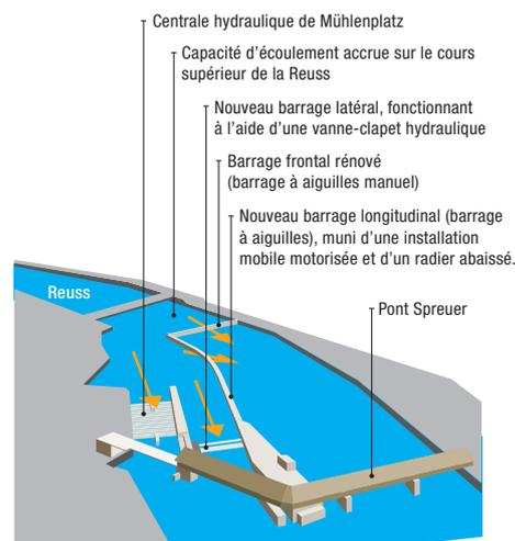
*Dans l'ouvrage assaini (graphique ci-dessus), le barrage latéral hydraulique assure la régulation fine tandis que le barrage à aiguilles permet une régulation grossière. Les interventions manuelles de régulation, difficiles et dangereuses, ont ainsi pu être réduites de moitié. Les aiguilles en bois du barrage longitudinal sont placées et retirées à l'aide d'un moteur; le barrage frontal continue d'être actionné à la main.*
