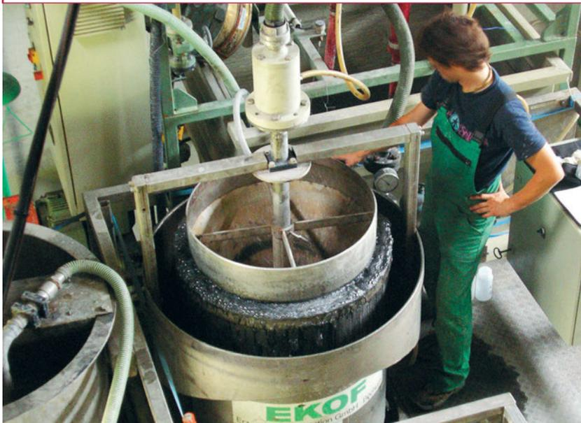
Installation pilote dans laquelle les particules de suie chargées de dioxine sont séparées mécaniquement des cendres volantes produites par les UIOM.
