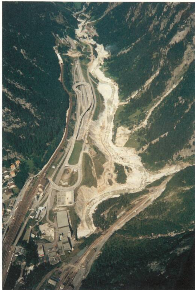
Photo 17: Erosion latérale de la rive de la Reuss à Gurnellen. On a tendance à considérer comme équivalents les dangers liés aux crues et ceux dus aux inondations. La cure de Gurnellen s'est effondrée dans la rivière à cause de l'affouillement de ses fondations.
