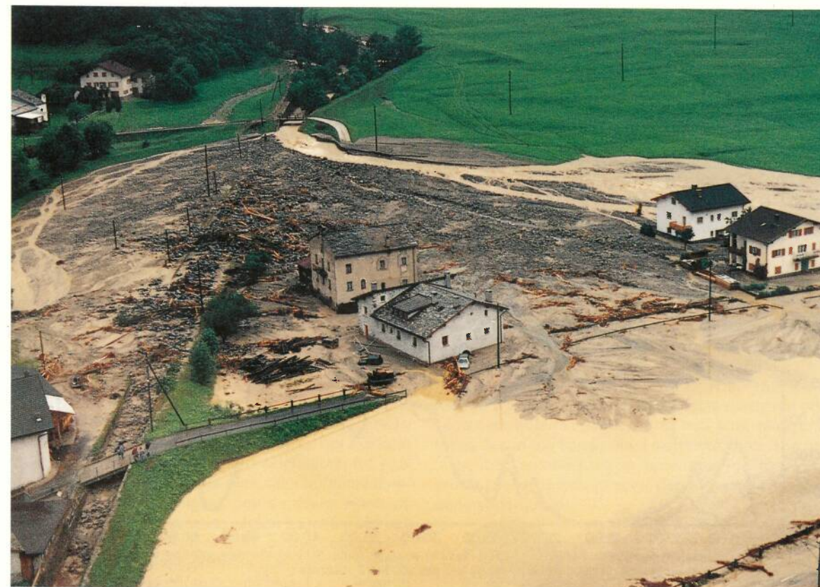
Photo 5: Val Viale dans la vallée de Poschiavo. La boue et les pierres des laves torrentielles se sont déposées en divers endroits sur le cône de déjection. Cela s'est produit ici entre deux ponts, où de toute évidence la totalité des matériaux a pu passer sous le premier pont.
