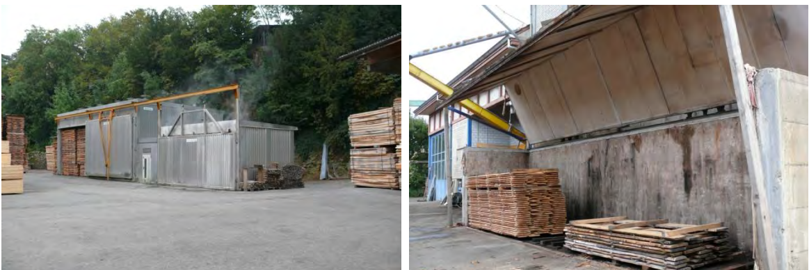
Abb. 7: 35% des Schnittholzes wird getrocknet (links), 10% gedämpft (rechts)
