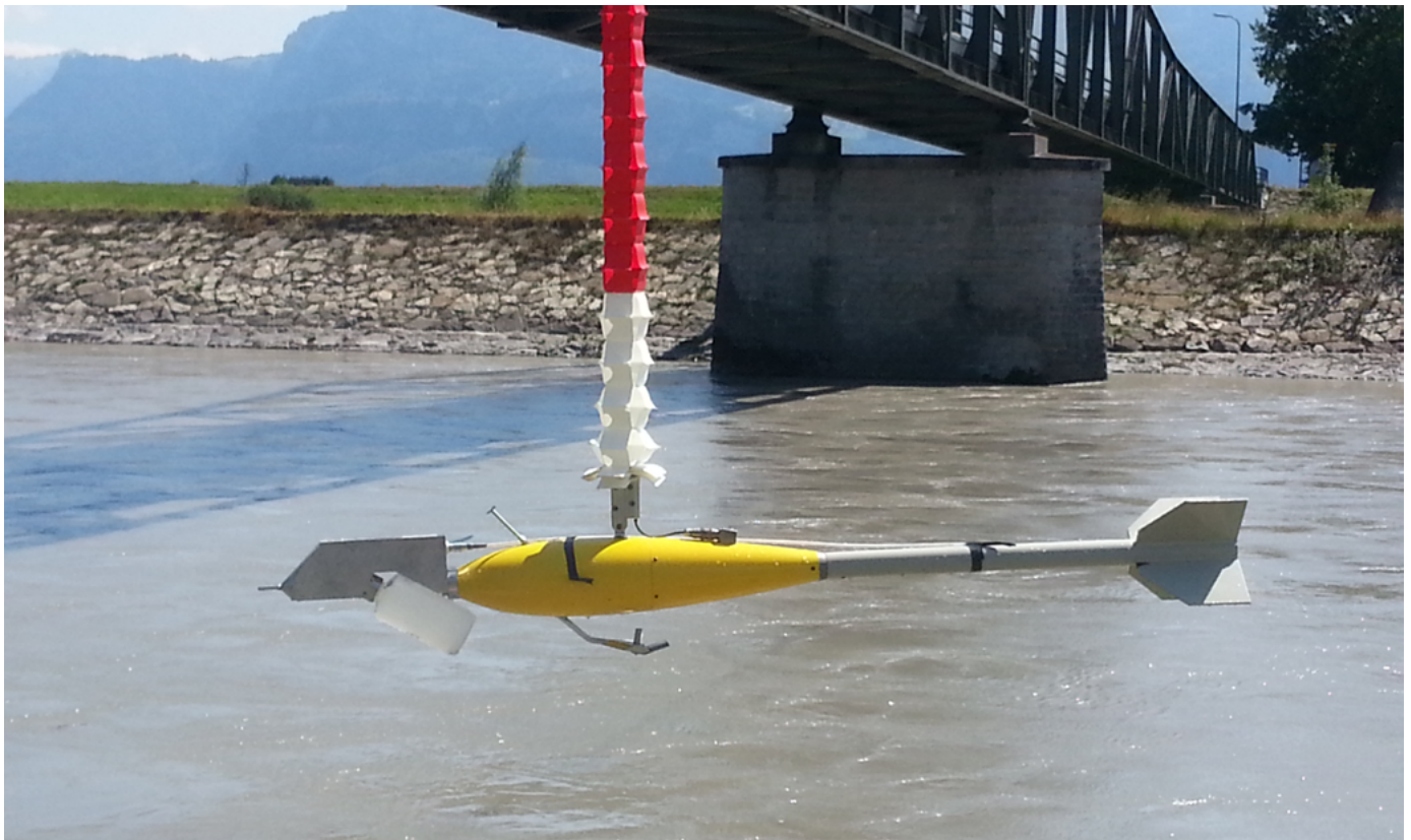
Bild 1: Vorrichtung zur Entnahme von Schwebstoffproben.
