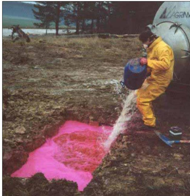
Figure 9: Injection de sulforhodamine dans une fouille.
