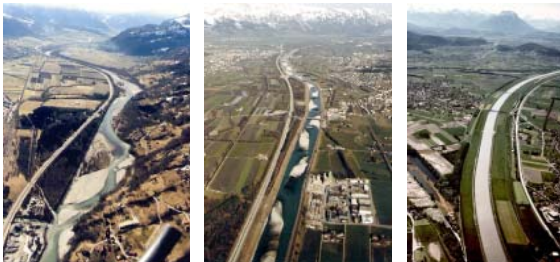
Fig. 7: Variété morphologique des tronçons étudiés dans le Rhin alpin. A gauche: entre Zizers et Landquart, avec la zone alluviale de Mastrils; vue vers l'amont. Au centre: entre Triesen et Vaduz, avec bancs de gravier alternés; vue vers l'aval. A droite: tronçon international du Rhin près du passage de Diepoldsau, lit majeur étroit avec francs-bords. Tiré de: ARGE TRÜBUNG ALPENRHEIN (2001).
