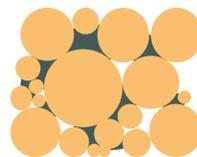
La *saturazione residuale* indica la quantità massima di liquido che può essere assorbita da un materiale di matrice senza che la fase liquida fuoriesca per l'effetto della gravità.
