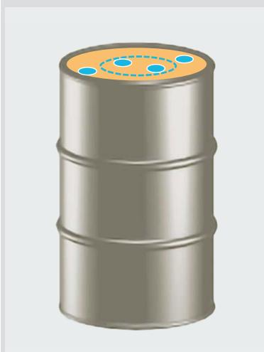
Ulteriore trattamento: costituzione del campione composito
